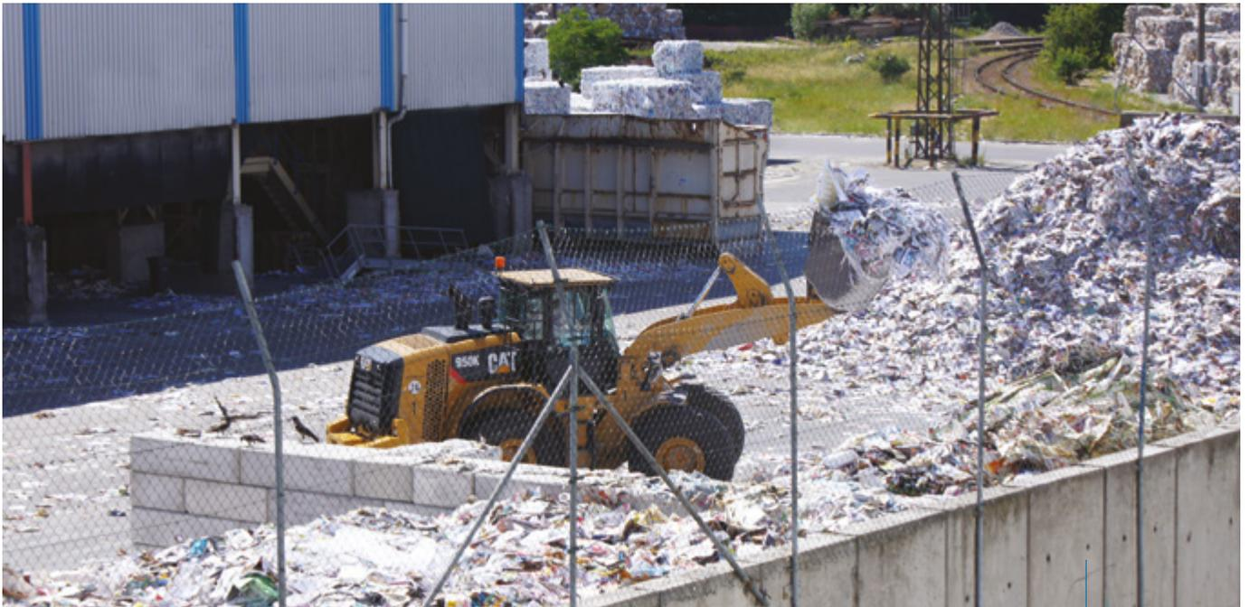
松散的脱墨浆原料（杂志和报纸）和涂布杂志被送入1#脱墨浆线。
